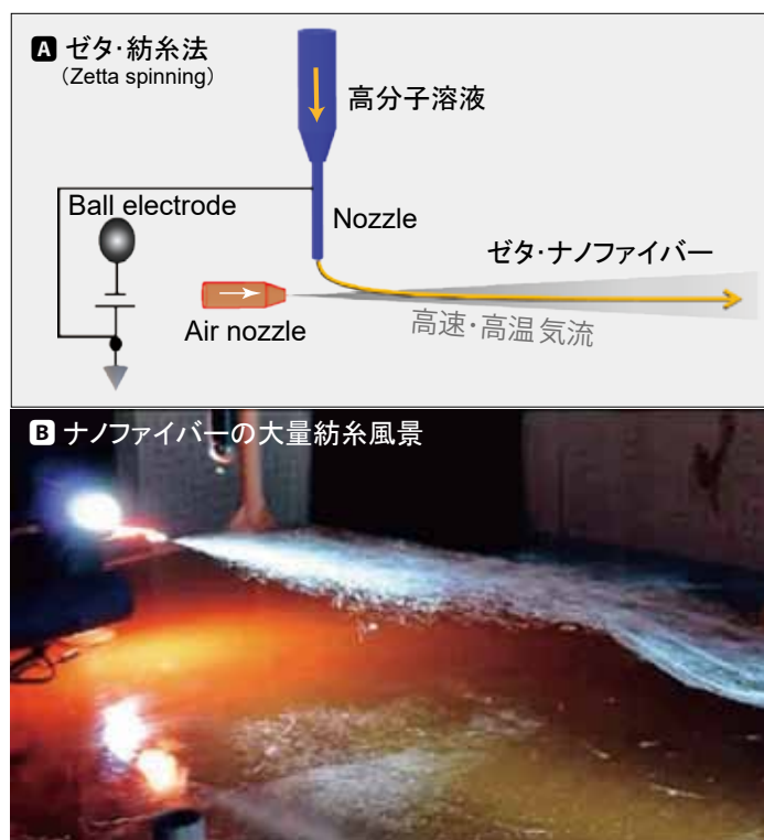
⑦ (A) 谷岡明彦名誉教授らが開発したゼタ紡糸法の原理。ここでは溶媒法を模式的に示しているが、熔融法にも応用できる。高電圧をかける際に、ノズル（直径 2 mm）側を接地すること及びボール電極を Air ノズルの後方に配置することにより爆発等の危険を回避できるように工夫されている。ノズルからの吐出速度：2 mL/min、ノズルとナノファイバー収集器との距離：1.5～2 m、ジェット気流速度：180 m/s。熔融法の場合の生産量は 1～2 kg/h。(B) 実際のナノファイバー大量紡糸実験の様子。【出典】A: Ind. Eng. Chem. Res. 55, 3759–3764, 2016. B: 蔵前ジャーナル No. 1083, 42–46, 2021。
