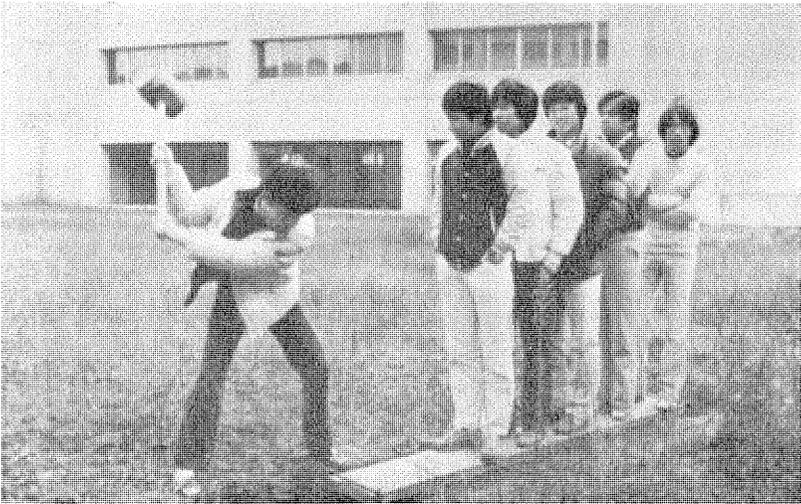
板叩きによる弾性波探査の実習風景
