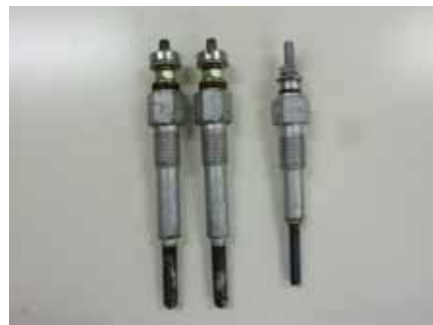
⑤ グロープラグ（ディーゼルエンジンの補助点火装置）。右が改良型で左の2本が旧型。
