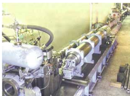
⑧ 三段式軽ガス銃。全長 10 m の飛翔体自由飛行部を擁する。旧応用セラミックス研究所 R3-B 棟地下に設置されていた。〔出典：応用セラミックス研究所ニュースレター No. 10, p. 9, 2003 年 5 月〕
